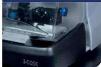
Per garantire la vostra sicurezza, la cupola di plastica di protezione e il vassoio di raccolta delle scaglie bloccano il funzionamento della macchina quando sono aperti.
