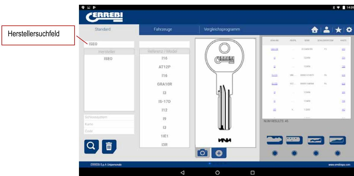
**Fall 2:** Einen ERREBI-Schlüsselrohling definieren und ermitteln, welche Serie mit diesem Schlüssel verknüpft ist.
