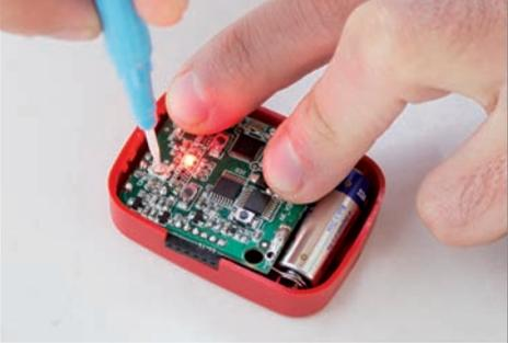
**7** Tenendo premuto il tasto di regolazione, muovere con un cacciavite il trimmer per regolare la potenza. Il LED rosso si illuminerà e lampeggerà più velocemente, a seconda dell'avvicinamento al punto di potenza ottimale.
